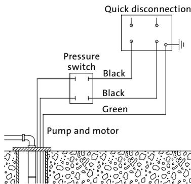
Fig. 4 Wiring diagram
